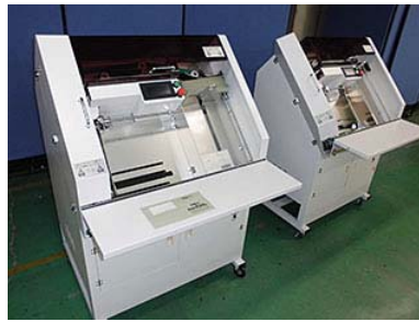
書状自動押印機 G3。定形サイズの封書とハガキが混合していても同時に押印できる点が画期的と評価されました。
